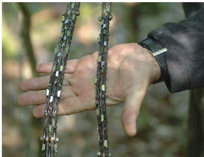
▲ Gerät zur Ringelung (zweireihige und dreireihige Ausführung) © Marc Wagner
