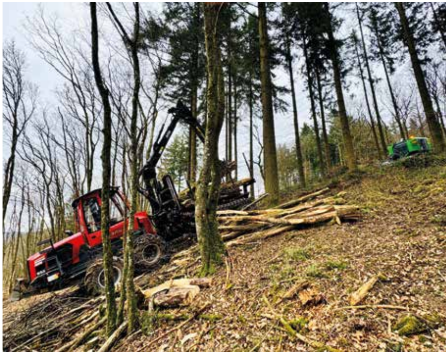
Rückzug im Hang – kontrollierte Holzbringung durch Seilunterstützung.
