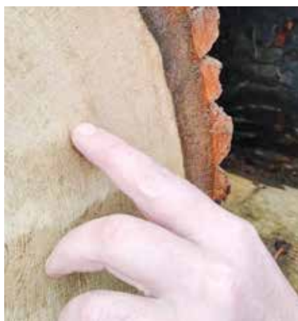
Entscheidend für die Verwendung zum Fassholz: enger und gleichmäßiger Jahrringaufbau
