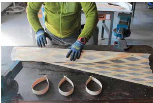
In Serienfertigung wird die Hülle zusammengerollt und mit Haltebändern aus Holz in Form gehalten.
