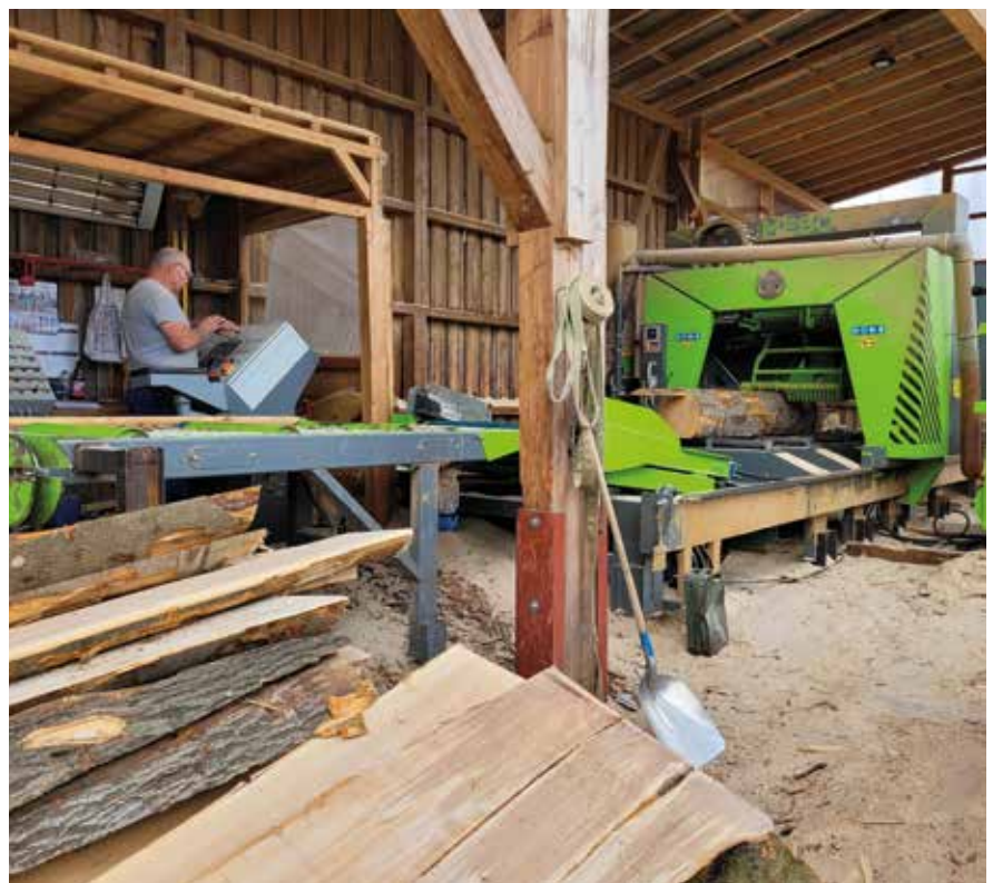
Vor 3 Jahren wurde in eine Bandsäge investiert, um Laub- und Starkholz einzuschneiden
