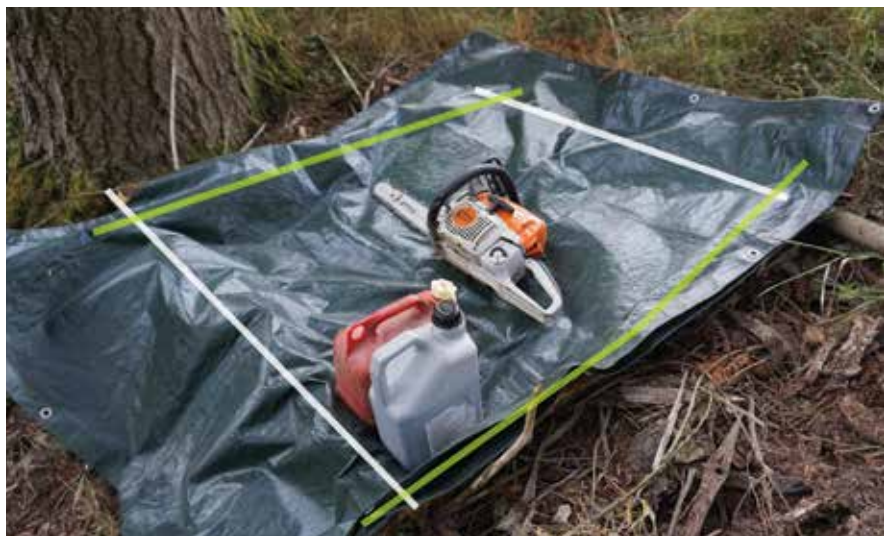
Aufbau eines Tankplatzes für Motorsägen mittels Plane mit, für die Dauer der Betankung, abgestellten Kanistern
