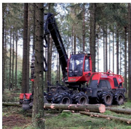
Ein 8-Rad-Harvester ermöglicht eine sichere und schonende Holzernte.
