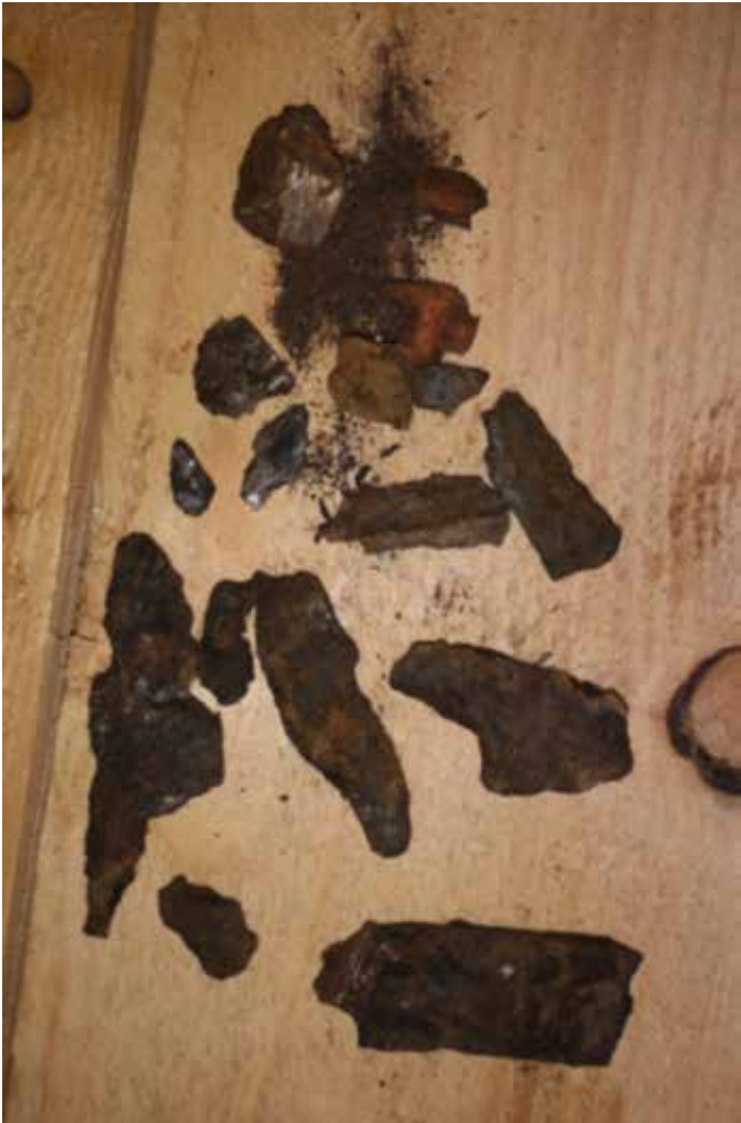
Abbildung 3: Metallrückstände die beim Aufsägen von Stammholz im Revier Echternach gefunden wurden.
