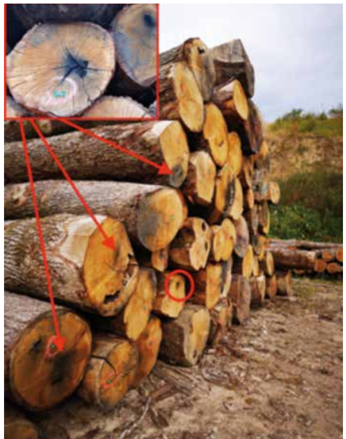
Abbildung 1: Splitterhaltiges Eichenstammholz, gut zu erkennen ist die bläuliche Verfärbung am Stammfuß.
